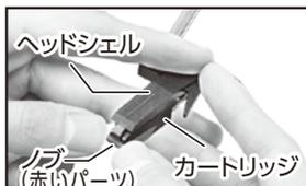
カートリッジのノブ(赤いパーツ)先端の両角に、親指の先をのせます。ひとさし指・中指で『ヘッドシェル』を固定します。
