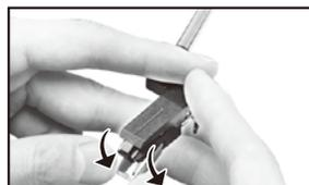
ノブ底面の奥側を支点にするようにしてノブ先端の両角を押し下げます。
